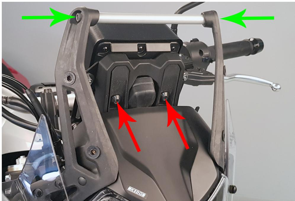
**(DE)** Die Verschraubungen der Querstrebe (➡) lösen und die Stange entnehmen.
